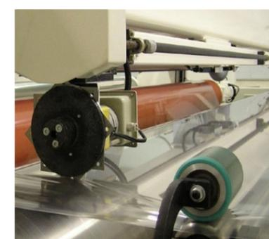
Questi rulli, che lavorano in coppia, vengono utilizzati per aumentare la tensione del film. Esistono due configurazioni possibili: un rullo gommato a contatto con un secondo rullo gommato, o un rullo gommato a contatto con un rullo metallico.
