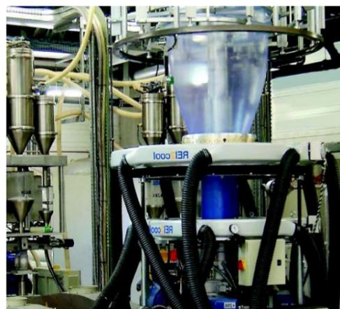
L'estrusione in bolla è il processo più utilizzato per la produzione e il confezionamento di film. Un estrusore circolare inietta il film all'interno di una bolla mediante soffiatura ad aria compressa. La bolla viene quindi compressa al fine di ottenere un film sottile a doppio strato.
