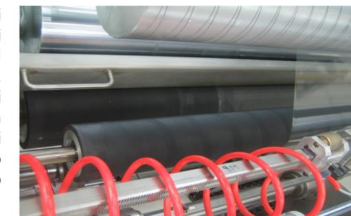
Questa soluzione può essere utilizzata per eliminare le pieghe durante la laminazione di sottostrati delicati ed è consigliata anche per alte velocità di avvolgimento e per il taglio di film e fogli plastici molto sottili. **Soft-Spreader** ha l'ulteriore vantaggio di essere rilevigabile senza perdere di efficacia. È disponibile in versione standard e antistatica.
