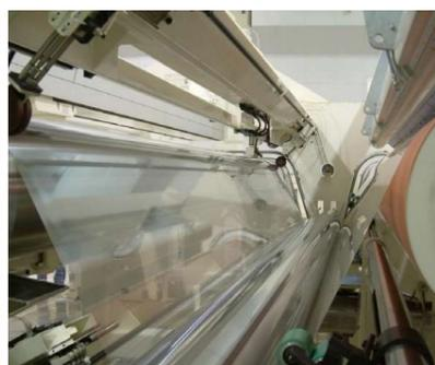
I film plastici biorientati vengono fabbricati prevalentemente in polipropilene (PP) o poliestere (PET), ma per applicazioni tecniche (elettroniche) o multistrato è possibile utilizzare anche altri componenti (PA, PVC, PS...).
